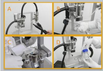
Bei der Saugextraktion über die Zykloneinheit werden die Partikel im Zyklon abgeschieden. Der Analysefilter dient lediglich als Überlastschutz.
