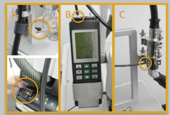
Die Erdung erfolgt über den Stromanschluss der Staubsaugereinheit mittels der Erdungsleitung (Art.-Nr. 61701). Die Differenzdruck-Messung wird mit dem Messgerät Testo 526-1 (Art.-Nr. 61714) überwacht.
